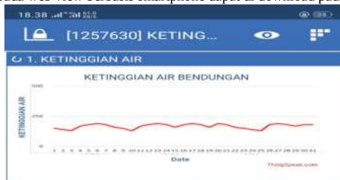
Gambar 16. Hasil grafik visualisasi hasil monitoring ketinggian air bendungan berbasis Android
