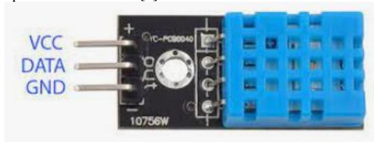
Gambar 2. Bentuk fisik Sensor DHT11
